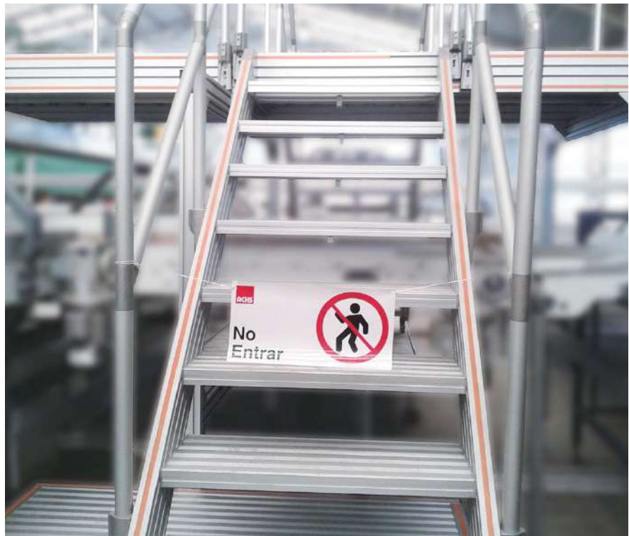
Bridge for Sorting Machine 分拣设备过线梯
