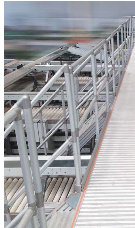
Bridge for Sorting Machine 分拣设备过线梯
